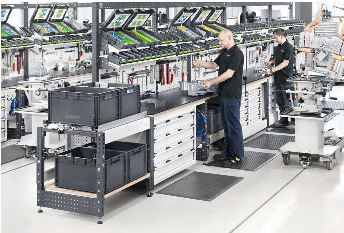
Les postes de travail multiples bott combinent plusieurs postes de travail rapidement et simplement afin de créer des chaînes de montage. L'utilisation de modules d'extension permet d'économiser des composants. La structure modulaire et solide composée d'unités librement combinées offre également la possibilité d'un montage double face. L'installation de la même chaîne de montage à l'arrière permet d'économiser jusqu'à 40 % des coûts d'acquisition.
