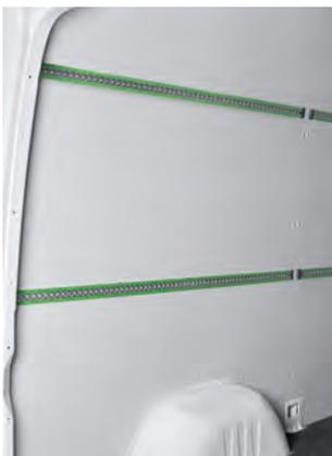
**bott vario protect Innenwandverkleidungen mit integrierten Ladungssicherungsschienen.**
