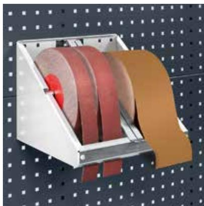
Porte-rouleaux à lame dentée pour une découpe facile. Convient à la fois aux rouleaux adhésifs et papier de verre. Axe de 16 mm pouvant recevoir des rouleaux de diamètres jusqu'à 270 mm avec une largeur maximale de 150 mm pour chaque section.
