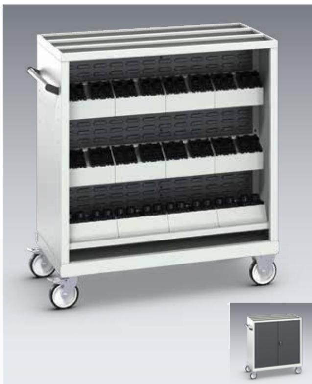
Chariot équipé double faces de panneaux à bacs, d'un dessus à rebords avec 3 bacs, poignée de manutention et 4 roues de diamètre 125 mm (2 fixes, 2 pivotantes avec frein).
