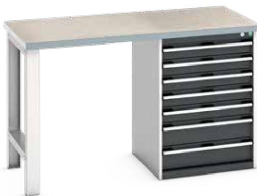
Dimensions du caisson LxH 650x900 mm. 6 tiroirs : 3x100, 2x150, 1x200 mm. Les établis de profondeur 750 mm sont équipés d'un caisson de profondeur 650 mm, les établis de profondeur 900 mm sont équipés d'un caisson de 750 mm de profondeur.
