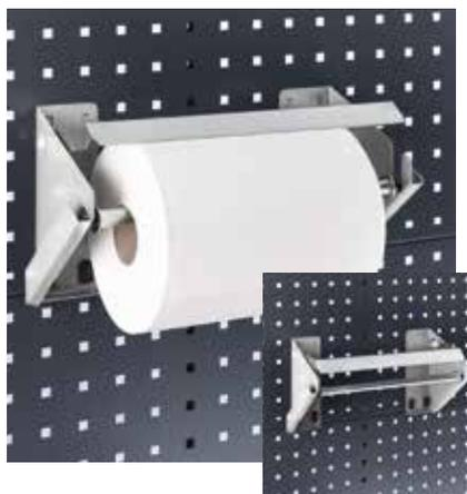
Dérouleur de papier avec système de coupe intégré. Equipé d'un axe de diamètre 16 mm pouvant recevoir des rouleaux de diamètre 280 mm maximum et de largeur 300 mm ou 700 mm.
