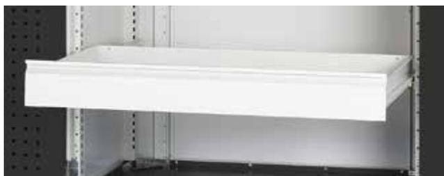
Tiroirs montés sur glissières à roulements. Charge par tiroir 75 Kg. Hauteurs 125 mm ou 175 mm. Réglables en Hauteur au pas de 25 mm.
